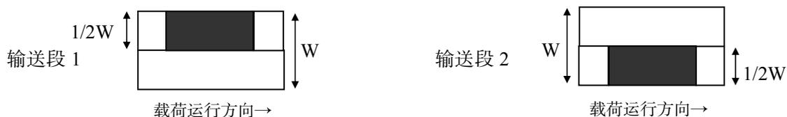
图 2 偏载试验区域示意
